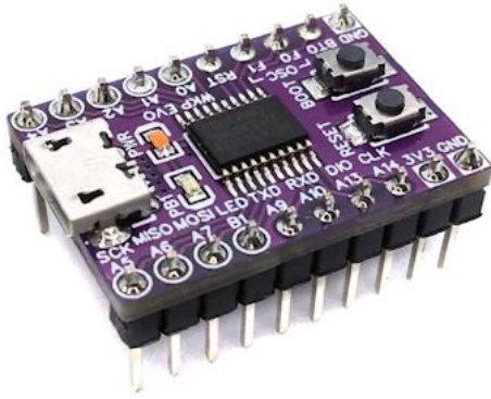
Рис. 22. Плата контролера STM32F030 та його характеристики
